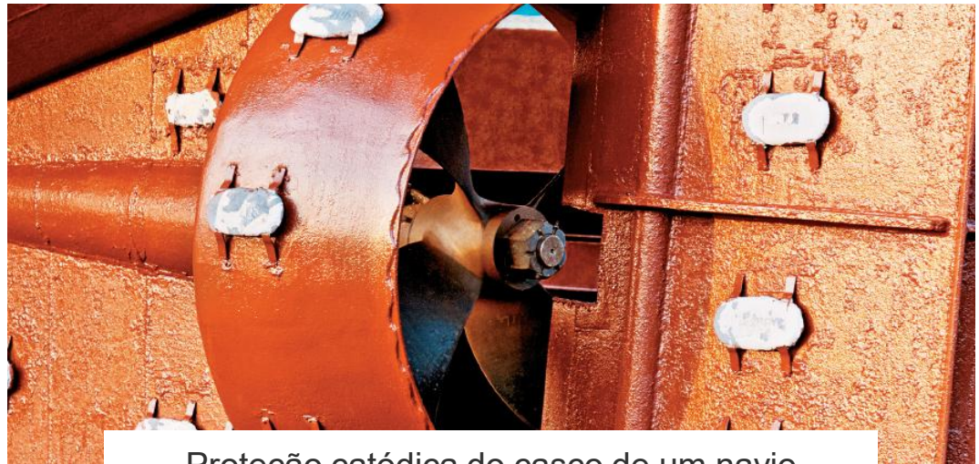
Proteção catódica do casco de um navio
